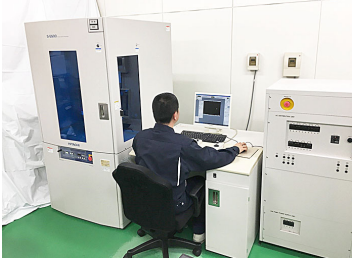
テクノセンター（上）に設置しているSEMなどを活用して、超高分解能画像を撮影する
